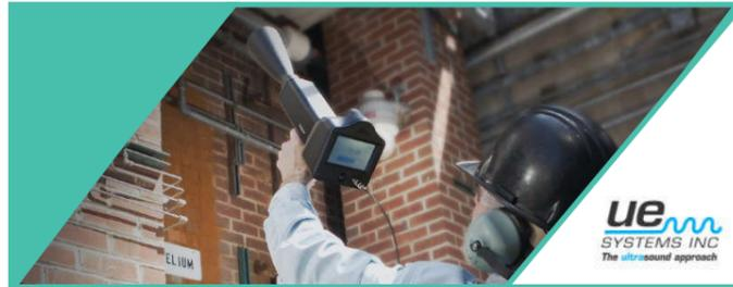
Los equipos de ultrasonidos, mediante diferentes accesorios de detección y el personal formado para ello, permiten rastrear una zona en búsqueda de fugas. Una vez localizadas, también nos permiten obtener datos fiables para su cuantificación, aportándonos información del volumen de las mismas y, por lo tanto, de su coste.
